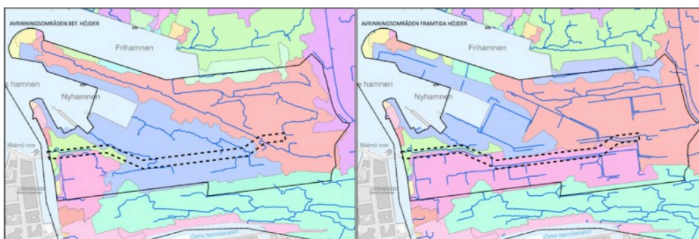
Utdrag ur höjdsättnings- och skyfallsutredningen som visar nuvarande och förslag till framtida avrinning. Till vänster: Avrinningsområden i nuläget. Till höger: Avrinningsområden efter att föreslagen höjdsättning har genomförts. Aktuellt planområde inom svart streckad linje.
